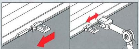
Montage der Anlage bündig mit der Fenstervorderkante.
